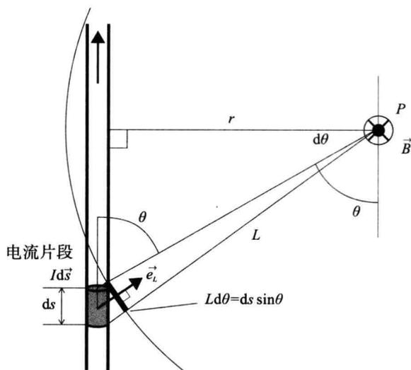
图 5.9 用毕奥-萨伐尔定律计算离电流距离为  $r$  的  $P$  点产生的磁场
