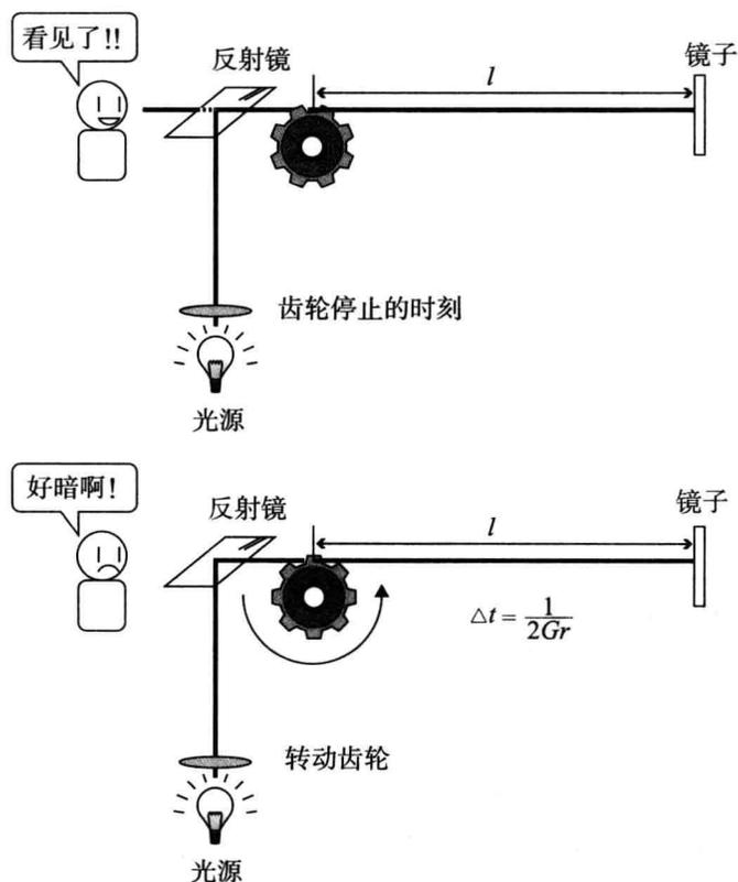
◆图6.10 光速计测方法的一例（斐索的研究方法）
