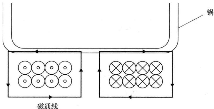
图6.14 IH加热器产生的磁通线和锅底的关系
