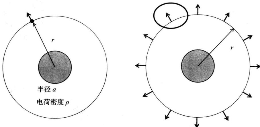
图3.1 用高斯定理求球状电荷激发的电场
