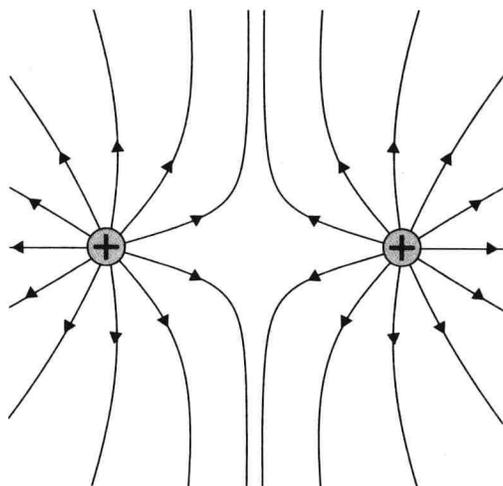
图 2.3 同符号、同大小的两个电荷和电力线
