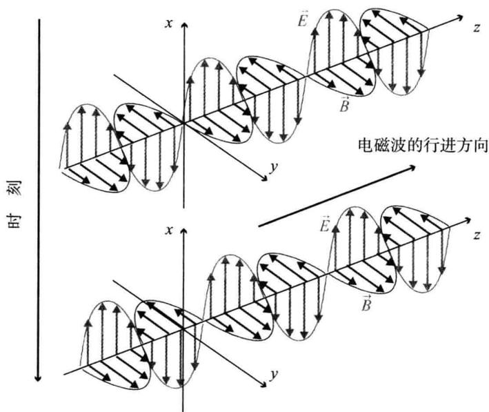
图 6.9 用矢量表示的在  $z$  轴方向上搬运电磁波的电场和磁场的形态依据时间的推进，沿  $z$  轴移动，整体搭配不发生变化
