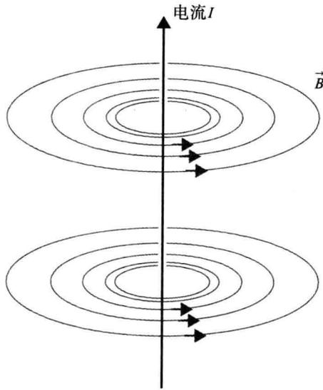
图 5.5 无限延长的直线电流周围的磁场
