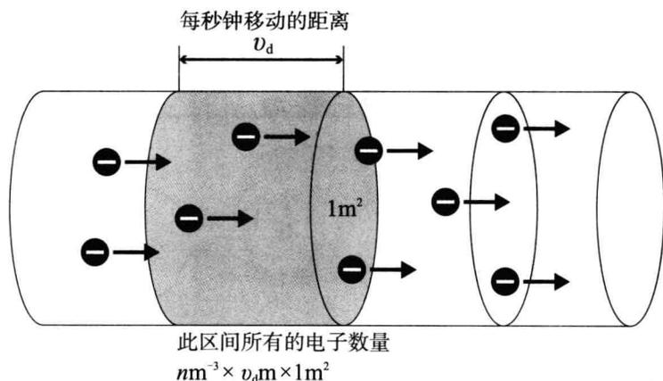
图 4.1 在截断面积  $1\text{m}^2$  的导线中移动的电荷与电流的关系
