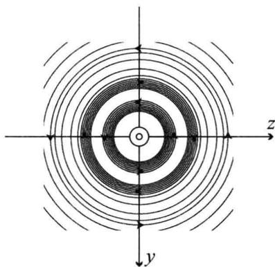
图 6.6 振动的电偶极子周围形成的磁通线
