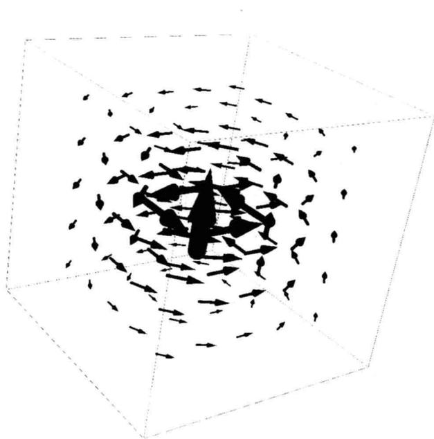
图 5.2 电流片段激发的磁场
