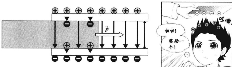
图3.8 电容器夹住的电介质的作用力
