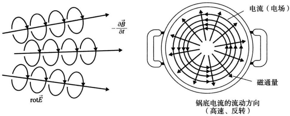
图6.15 与变化的磁通（浓色）纠缠在一起的电场（淡色）。合成的电力线围绕锅底。电流沿电场方向流动
