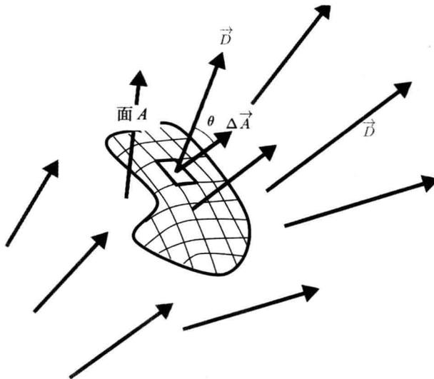
图3.4 计算电通量使用内积和面积分
