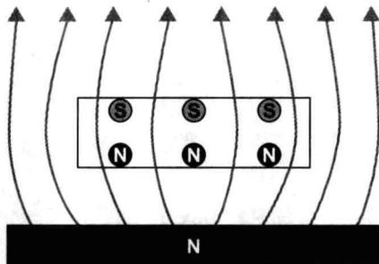
◆图 5.17 悬浮于磁石上方的抗磁性
