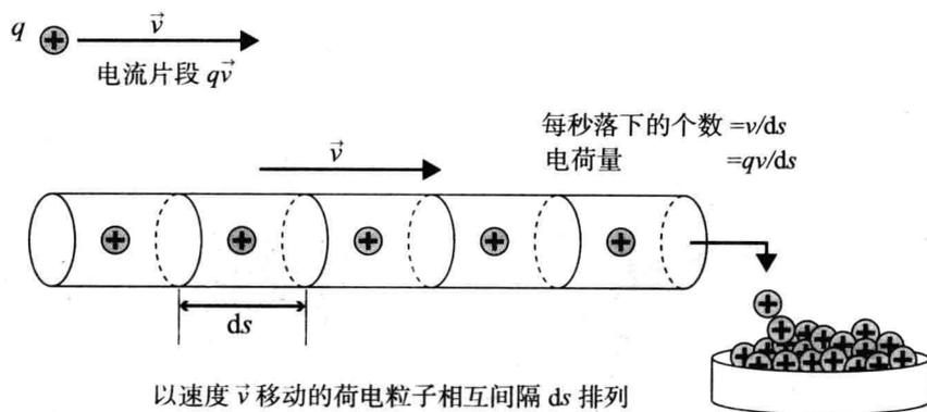
图 5.1 运动电荷和电流片段的关系
