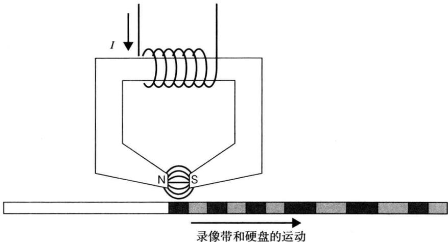
图 5.15 磁力记忆装置的原理
