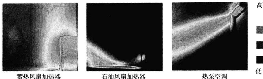
◆附图9 加热系统变化和相应的温度场
