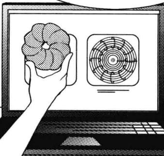
环圈电流和电磁石一样，也会生出通过内侧的磁通线。
