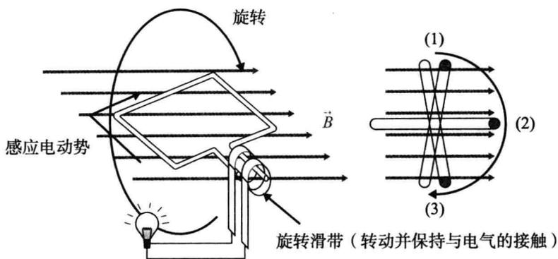
图6.11 发电机原理
