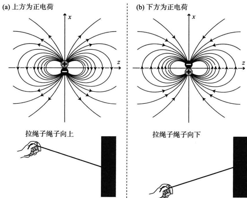
图 6.3 电偶极子构成的电场和对应绳线的状态
