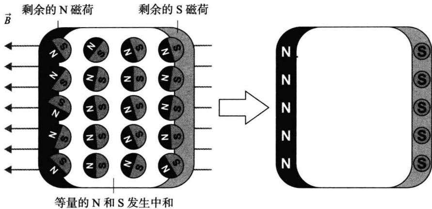
◆图 5.12 磁性体的磁化的假象磁荷图
