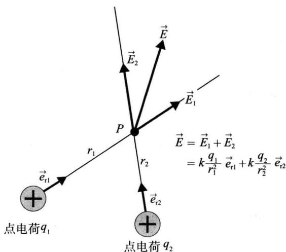
图2.4 电场的重叠原理
