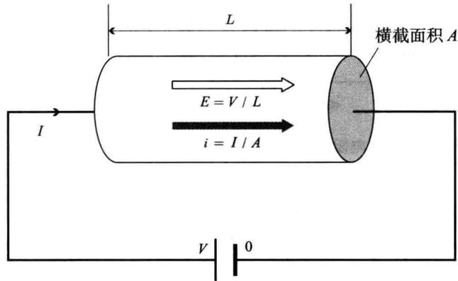
图 4.3 电气电路中使用的电阻器概念图
