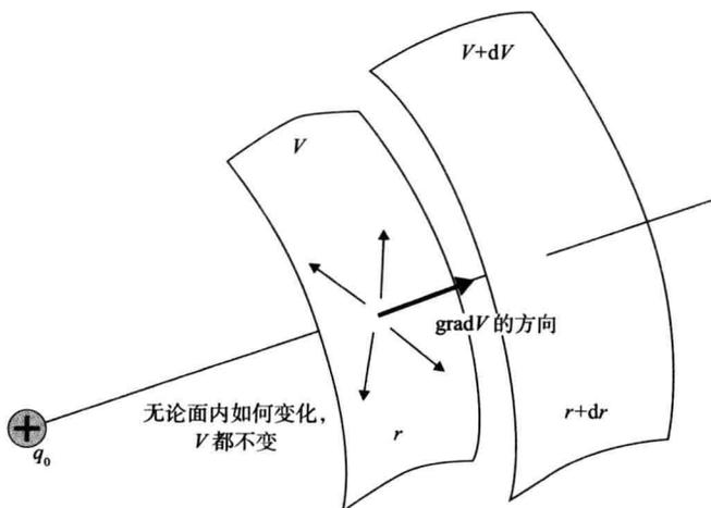
图 2.5 点电荷产生的电位和电场的方向
