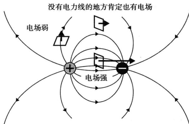
图2.2 相对的点电荷激发的电力线
