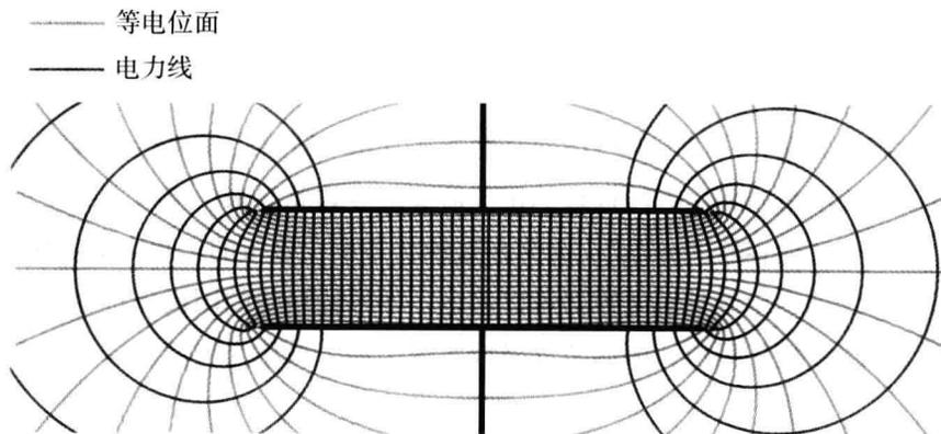
图 3.6 电容内部的电场和等电位面
